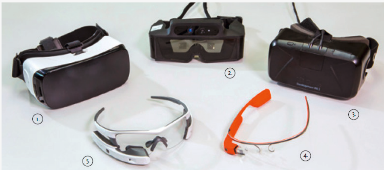
Abbildung 4: Verschiedene Head-Mounted-Display-Systeme (HMD)
