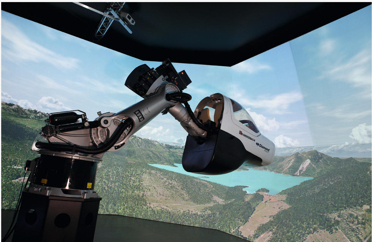
Abbildung 5: CAVE als rückprojektionsbasiertes Virtual-Reality-Display
